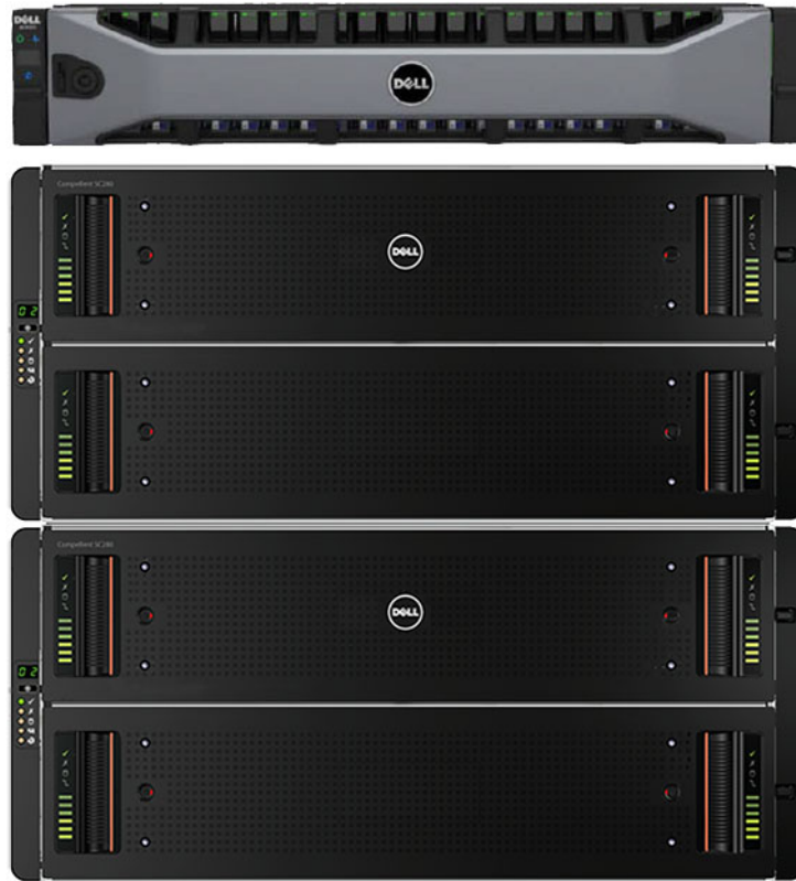
図 3.2 2 台の SC4020 ストレージシステムを搭載した SC280 拡張エンクロージャ
